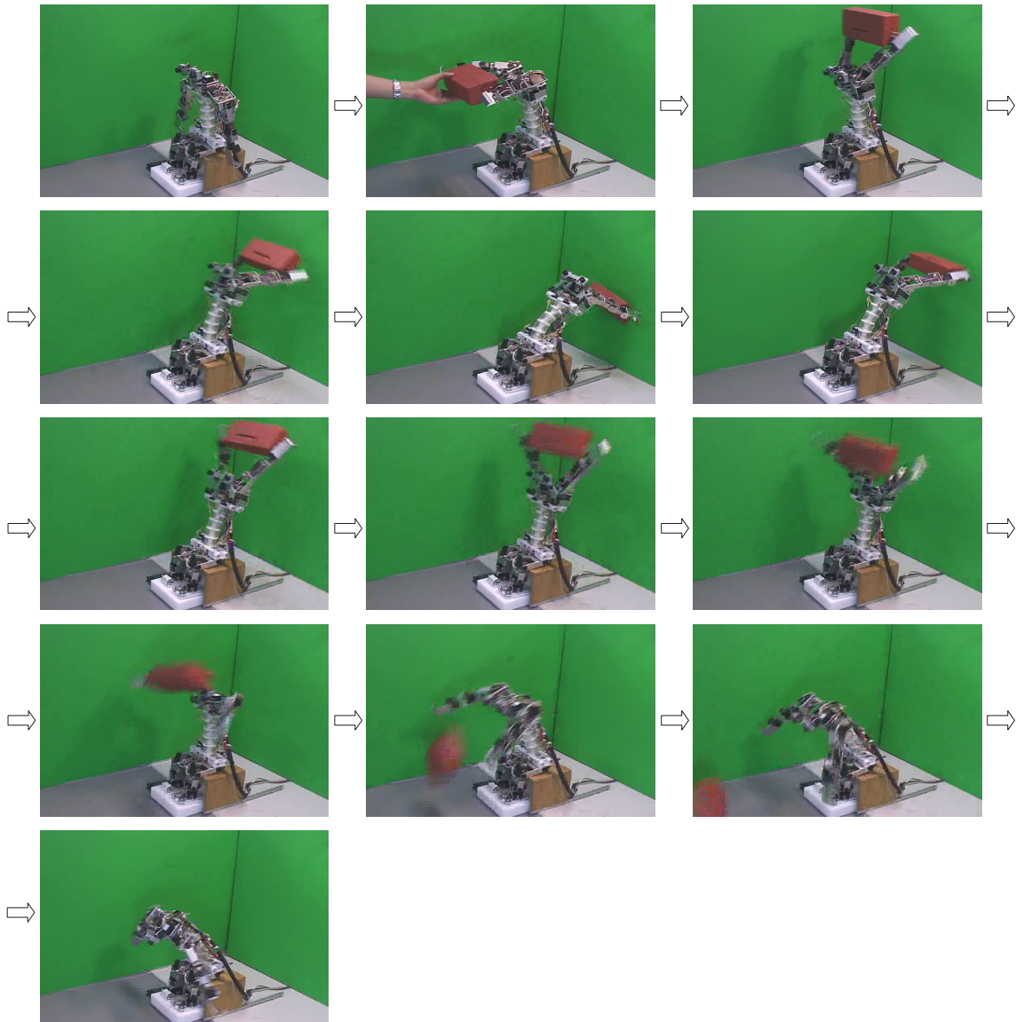
Fig. 5.3 脊椎を利用して物を投げる Cla Cla throwing an object using spine
